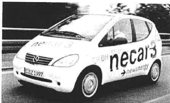
Mercedes N-car 3, brenselcellebil med metanolreformer, startklar etter ett minutt.
